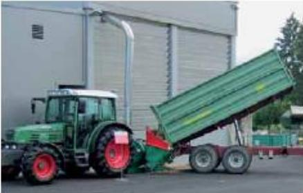
Un'altra possibilità è quella di stoccare il materiale tal quale (stanghe) in prossimità del silo e di cippare direttamente dentro il deposito ([www.deluca-woodenergy.it](http://www.deluca-woodenergy.it)).
